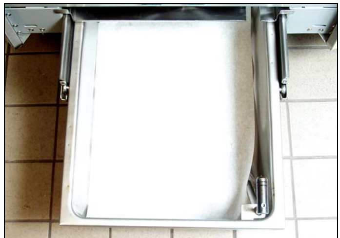
Ponga una hoja de papel de filtro o una almohadilla de filtro sobre la malla. Si usa la ALMOHADILLA, fíjese que el lado áspero quede hacia arriba.
